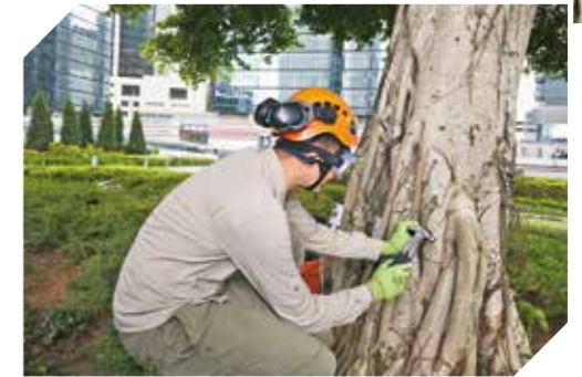
■ 利用微鑽阻力或聲納探測工具能更準確評估樹木內部結構。
