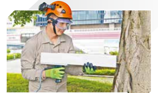
■ 利用微鑽阻力或聲納探測工具能更準確評估樹木內部結構。
