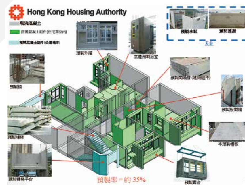
▲ 房屋署現採用構件式單元設計及大量採用預製組件，測試人員要肩負起把關的重任。
